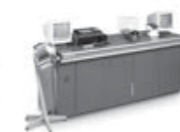
USTER® HVI 900 SA Система для полуавтоматического тестирования волокна
