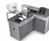
USTER® HVI 900 A 第三代纤维长度、纤维整齐度和短纤测试仪
