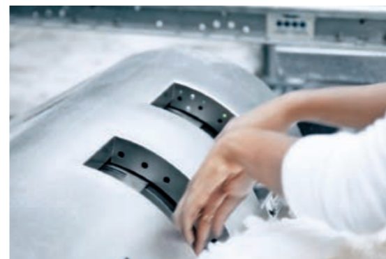
上图： USTER® HVI 1000运用专利的氙光技术进行色泽测试
