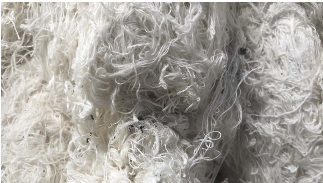
图3 络筒机产生的工业废料（硬废料）
