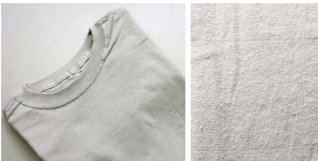
图24 具有有害疵点的针织物
