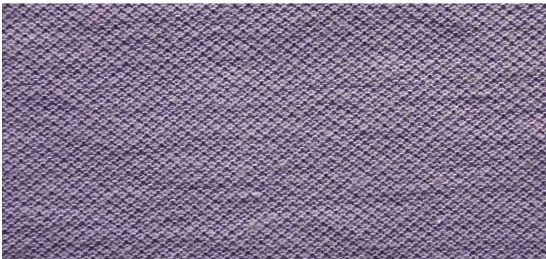
图23 由于纱线不匀率高而导致针织物表面不匀率高
